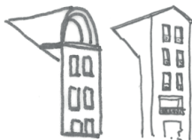
Des pignons en façade principale
